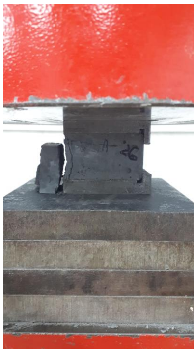
2-сурет. «Technotest» KD 300/R пресінде өздігінен нығыздалатын бетонның қысу беріктігін анықтау
