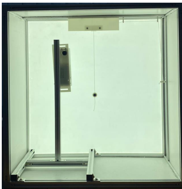
1-сурет. Математикалық маятниктің қозғалыс заңдылықтарын зерттеуге арналған әзірленген құрылғының түрі
