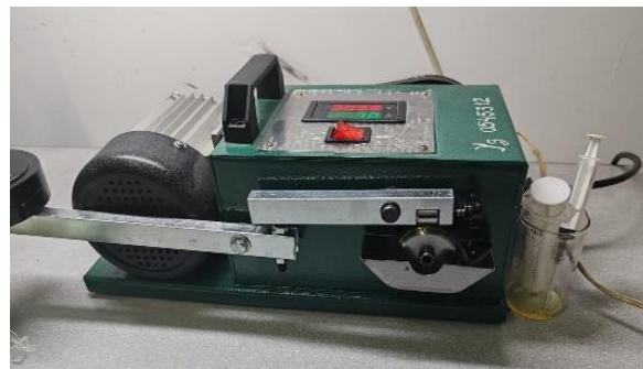
1-сурет. Майлардың үйкеліс және тозуға қарсы қасиеттерін бағалауға арналған
