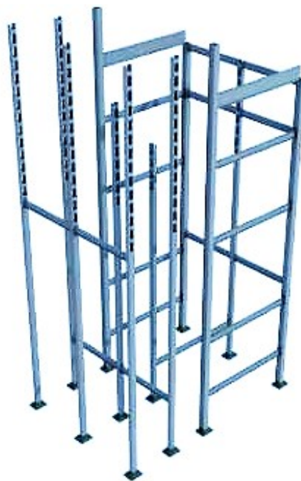
Рисунок 1. Каркас котлоагрегата № 5 котельного цеха первой очереди ТОО «Главная распределительная энергостанция Топар»
