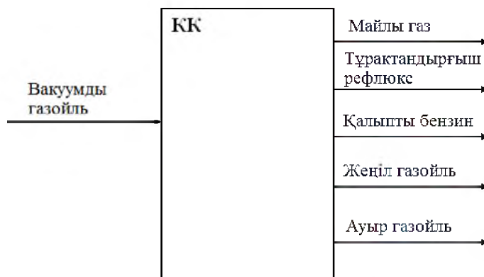
2-сурет. Каталитикалық крекинг қондырғысы өнім ағыны сұлбасы
