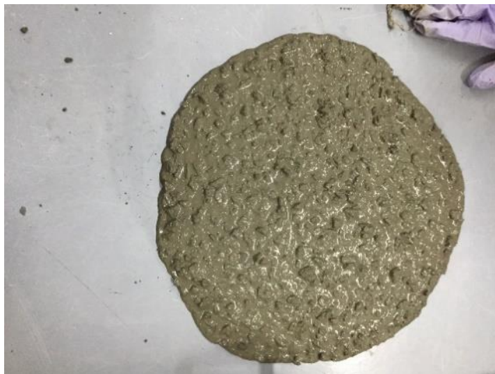
3-сурет. Қиыршық тасты ұсақтау өнімдерінен алынған тас ұнтағы қосылған бетон қоспасындағы су бөлінуі
