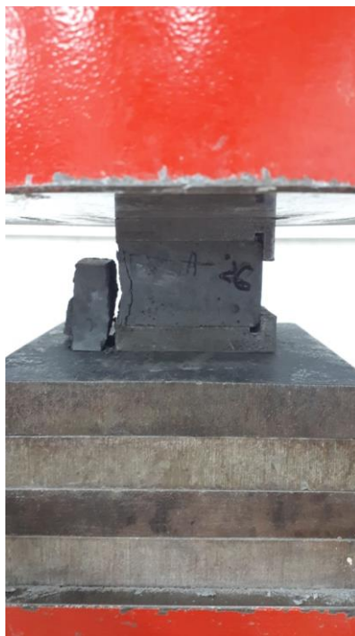
2-сурет. «Technotest» KD 300/R пресінде өздігінен тығыздалатын бетонның қысу беріктігін анықтау
