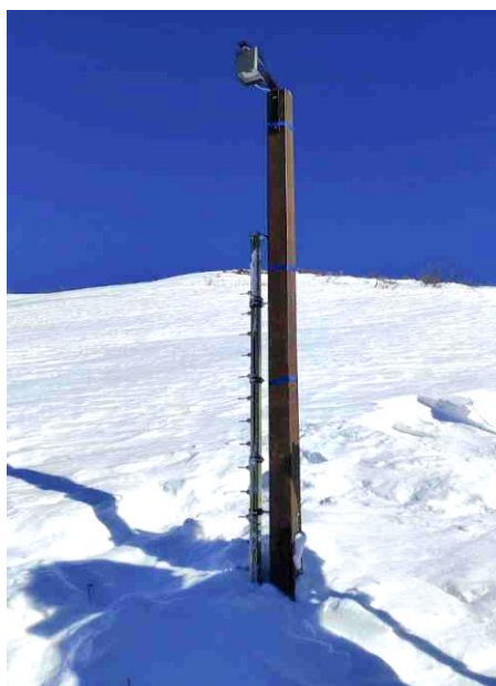
Рисунок 9. Температурная снегомерная рейка, установленная на склоне
