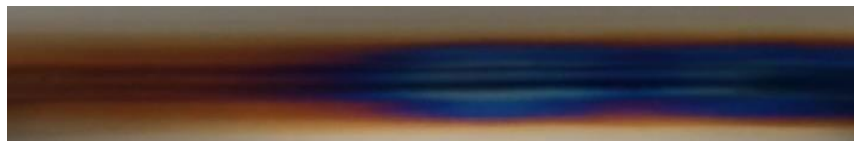
Рисунок 2. Изображения сварных соединений с дефектами: несплавление металла (а); окисленная поверхность металла (б)
