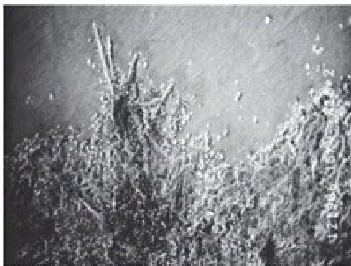
Рисунок 12. Миграция серебра по механизму роста дендритов
