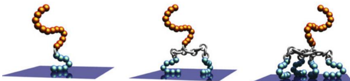
4-сурет. Бір немесе бірнеше TBPs (көк), пептидтік байланыс (күміс) және PEG (алтын) бөлшегі бар бактериофобты жабындар [18]
