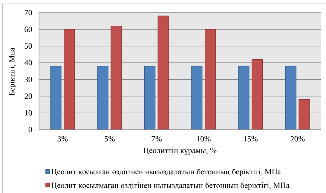
5-сурет. Тұрақты C/Ц = 0,3 кезіндегі өздігінен нығыздалатын бетонның беріктік қасиеттерінің нәтижелері
