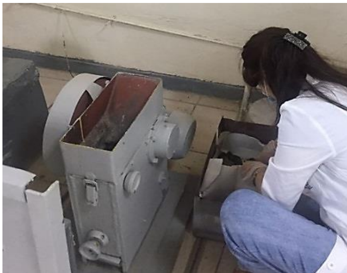
Рисунок 1. Дробление стекла в дробилке
