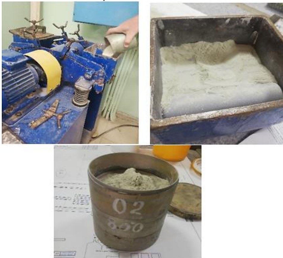
Рисунок 2. Подготовка мелкодисперсного стекла с помощью вибромельницы
