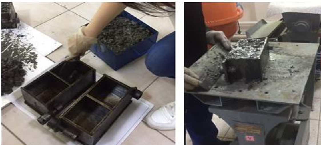
Рисунок 3. Заливка готовой смеси в кубические формы и уплотнение смеси на вибрационном столе
