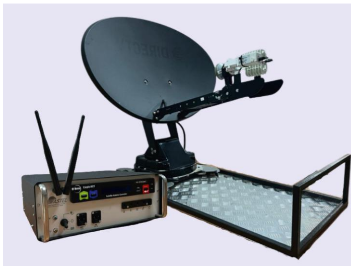
1-сурет. Автомобильдік байланыс кешені (АКС)
