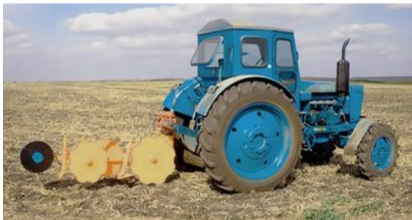
Рисунок 5. Опытный экспериментальный образец модели дисковой посевной секции при его полевой проверке
