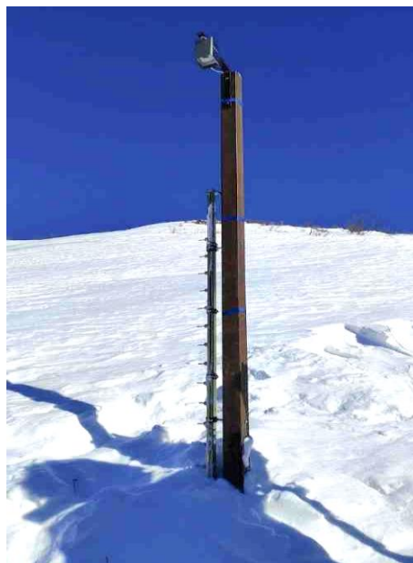
Рисунок 9. Температурная снегомерная рейка, установленная на склоне
