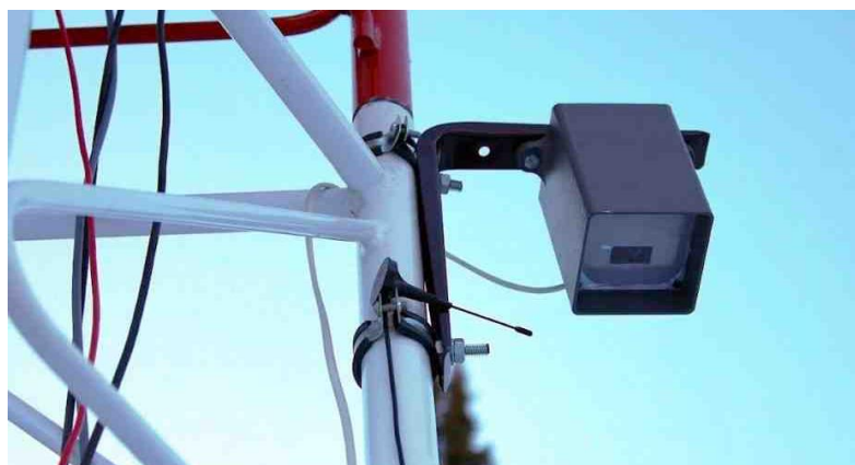
Рисунок 11. Приемник данных с температурной снегомерной рейки
