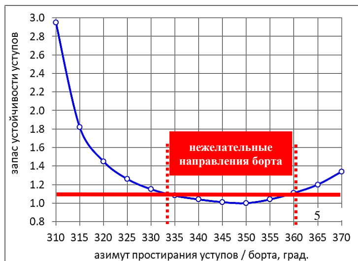
Рисунок 16. Зависимость устойчивости уступов от их направления
