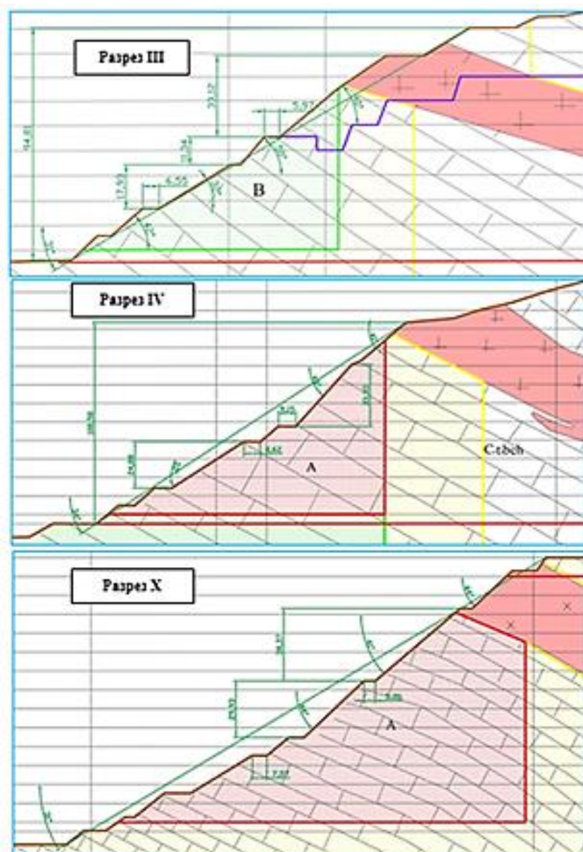
Рисунок 11. Расчетные схемы по разрезам СВ борта карьера
