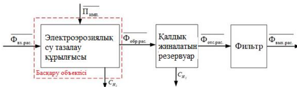
1-сурет. Суды тазартудың электроэрозиялық процесінің құрылымдық схемасы Ескерту (Надеждин, 2020) негізінде құрастырылған
