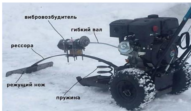
Рисунок 11. Опытный образец льдоскалывателя с упругим рабочим органом
