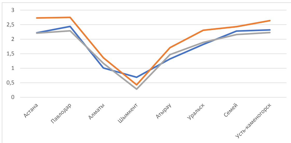
2-сурет. Қазақстанның әртүрлі ірі қалаларындағы топырақтың қату тереңдігі мен тоңдану ісіну тереңдігі
