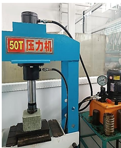
Рисунок 2. Гидравлический пресс для определения прочности брикетов-лизунцов
