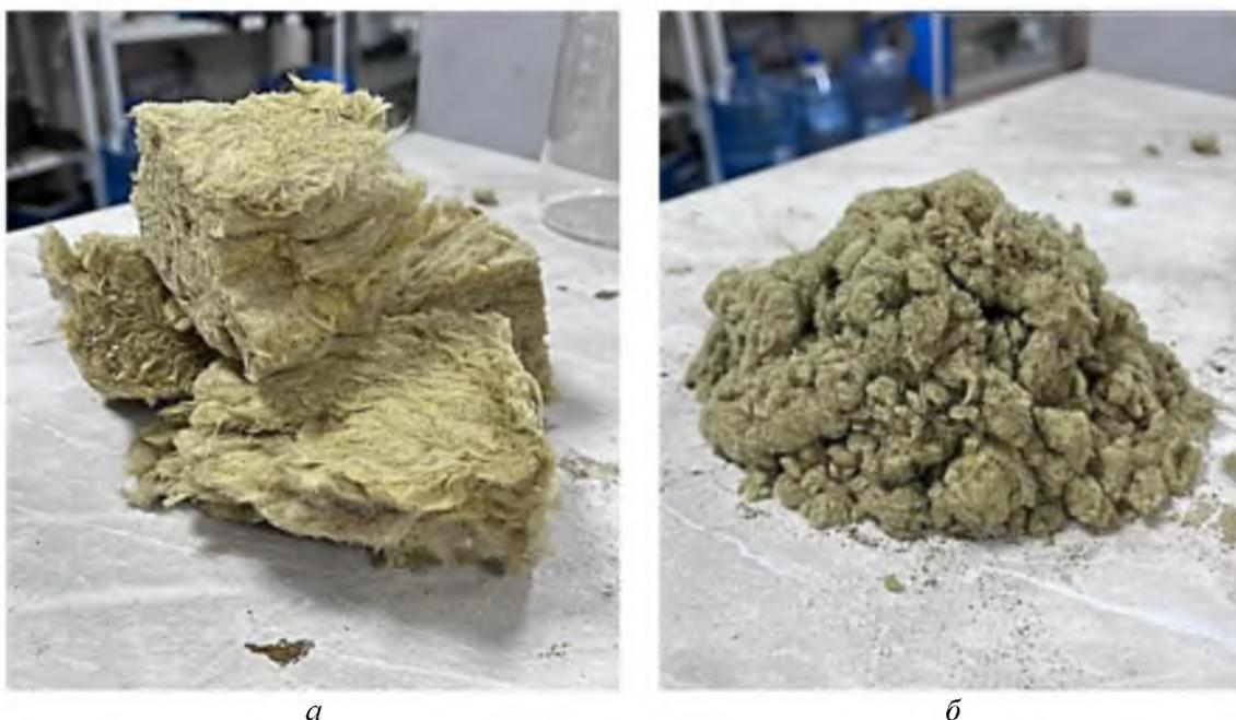
**Рисунок 1.** Отходы производства минеральных базальтовых утеплителей (а) и минеральной фибры (б)
