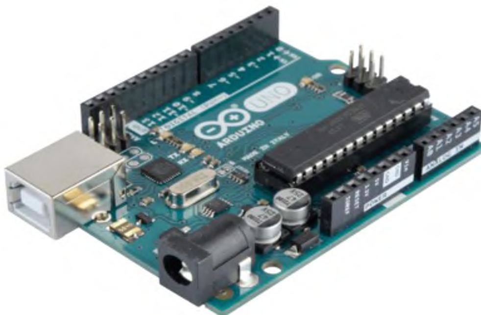
5-сурет. Arduino Uno R3 тақтасы
