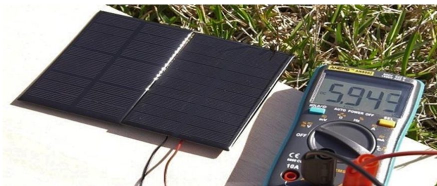
4-сурет. Күн панельдерінің параметрлерін табу үшін мультиметрді пайдалану
