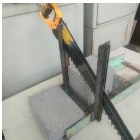
2-сурет. Блоктарды үлгі-текшелерге аралау
