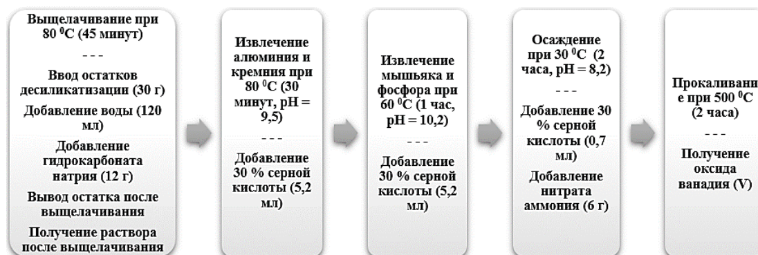
Рисунок 4. Технологическая схема извлечения ванадия из остатков десиликатизации
