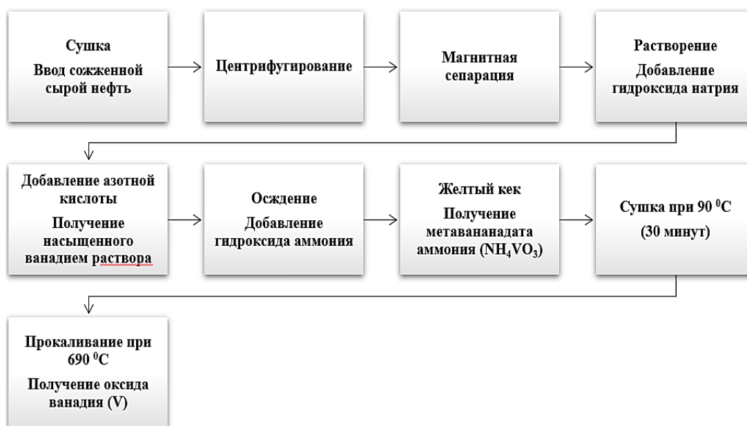
Рисунок 3. Схема извлечения ванадия из нефти и перевода его в оксид ванадия (IV)
