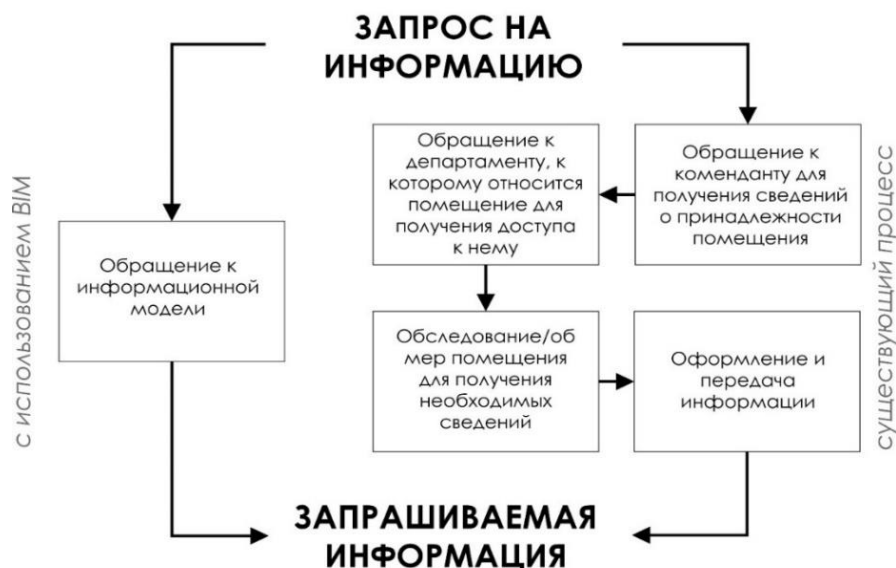
Рисунок 6. Сравнение двух процессов получения данных – существующего и с использованием информационной модели
