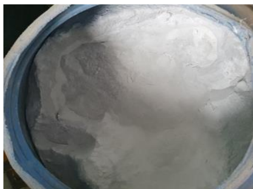
1-сурет. а – Әк-құм дайын қоспасы; б – № 008 фракциялы шынының қалдық ұнтағы Ескерту – автормен құрастырылған
