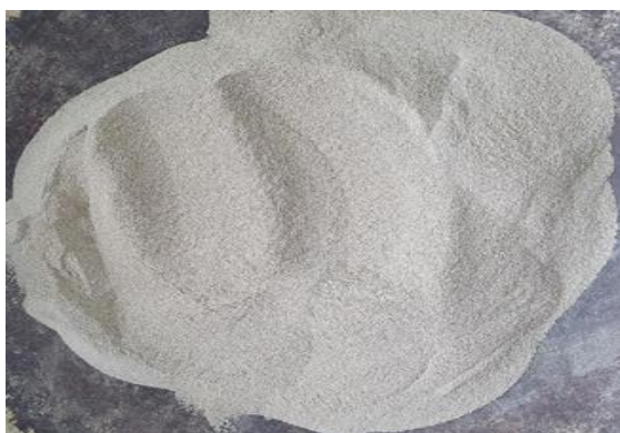
1-сурет. а – Әк-құм дайын қоспасы; б – № 008 фракциялы шынының қалдық ұнтағы Ескерту – автормен құрастырылған
