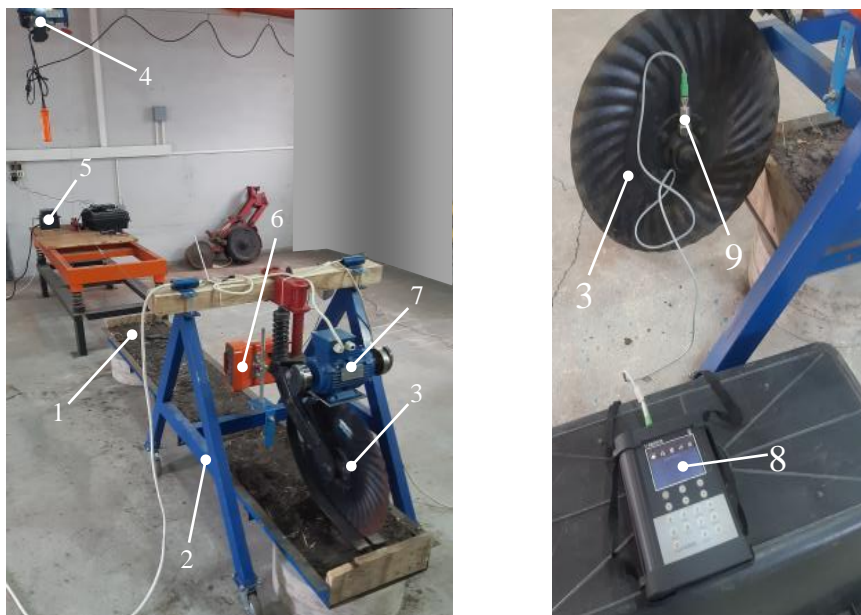
5-сурет. Қатарлар арасындағы ені мәнін ескермей, сепкіштің дірілдейтін дискілі жұмыс органдарын зерттеуге арналған эксперименттік стенд
