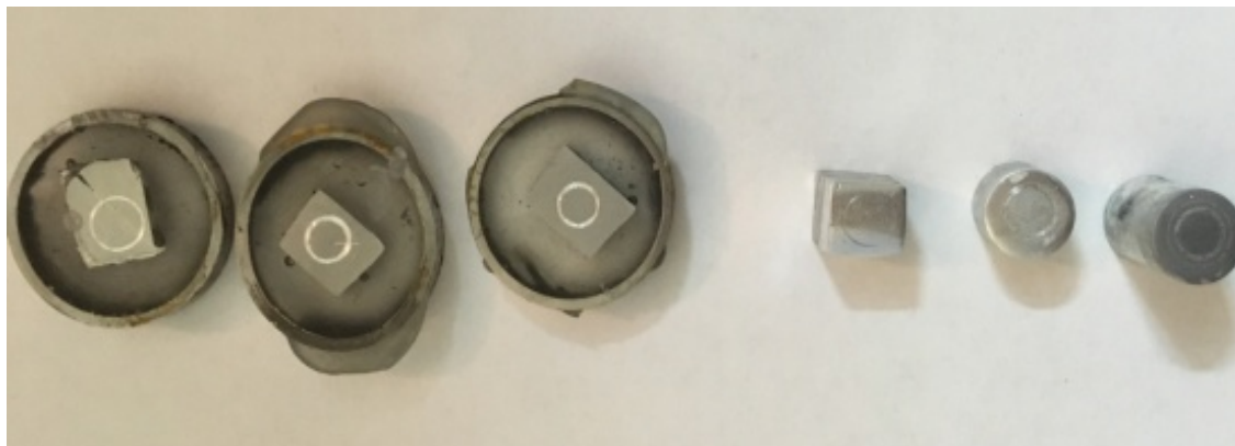
Рисунок 1- Подготовленные образцы алюминиевых сплавов АМГ6 и АМЦ для трибологических испытаний по схеме «шарик – диск»
