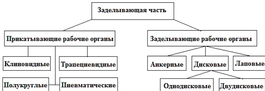
Рисунок 2. Основные типы заделывающих и прикатывающих рабочих органов
