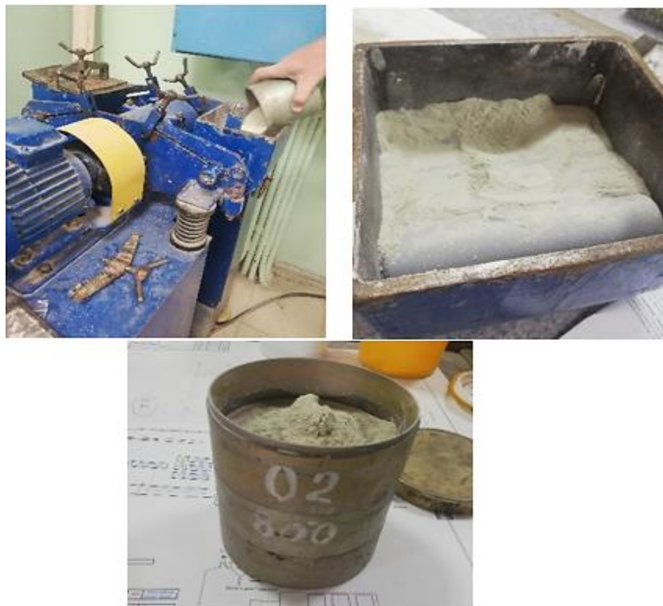
Рисунок 2. Подготовка мелкодисперсного стекла с помощью вибромельницы
