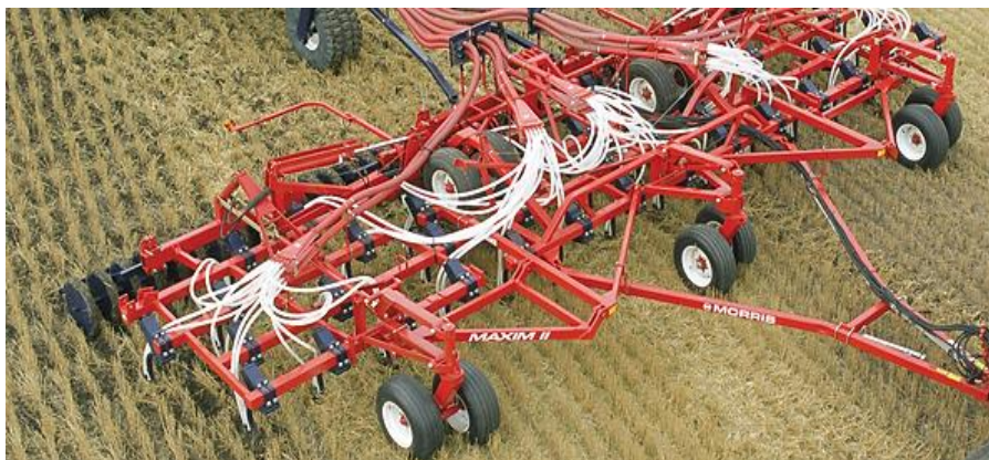
Рисунок 9. Широкозахватная сеялка культиваторного типа MorrisMaxim II
