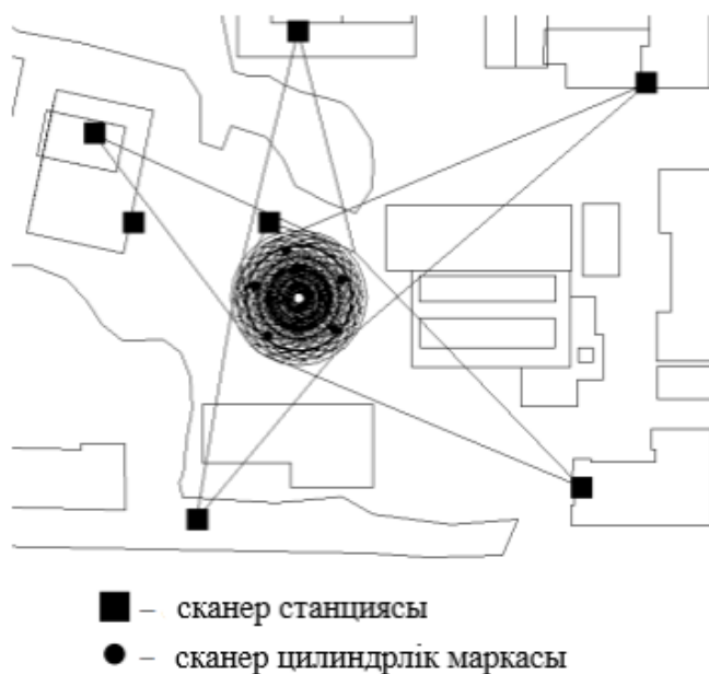
1-сурет. Сканер станцияларының орналасу схемасы
