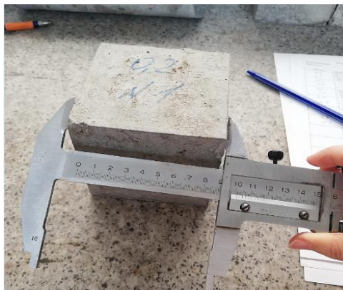
Рисунок 5. Обмер готовых образцов
