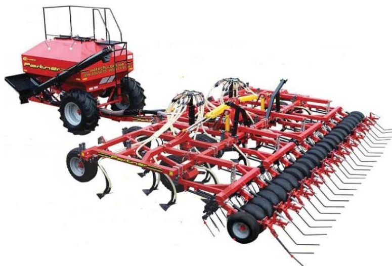
Рисунок 5. Посевной комплекс культиваторного типа «Partner» (Партнер)
