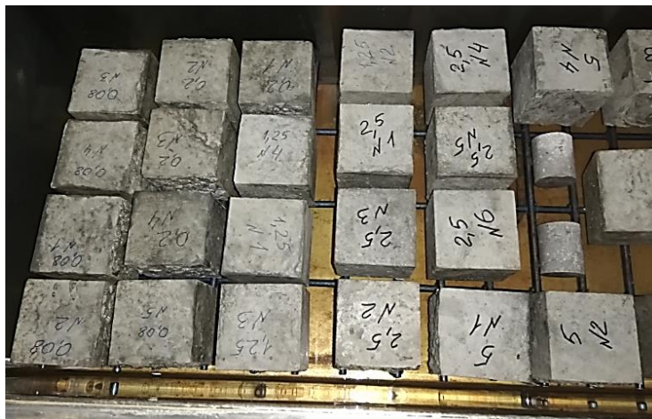
Рисунок 4. Готовые образцы в камере
