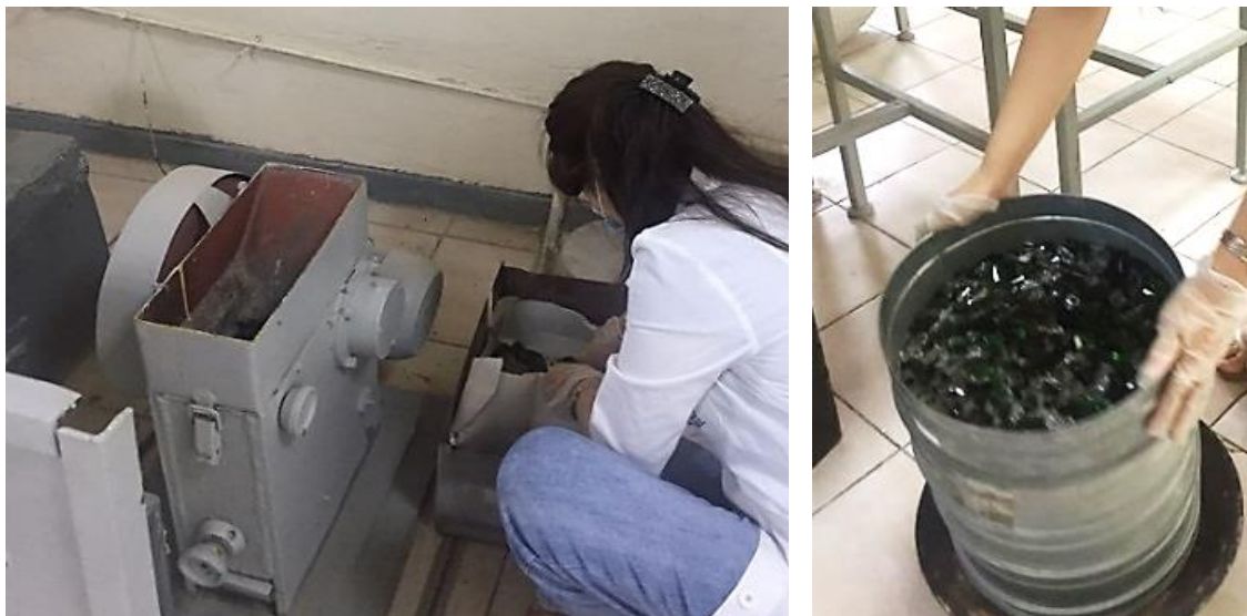
Рисунок 1. Дробление стекла в дробилке
