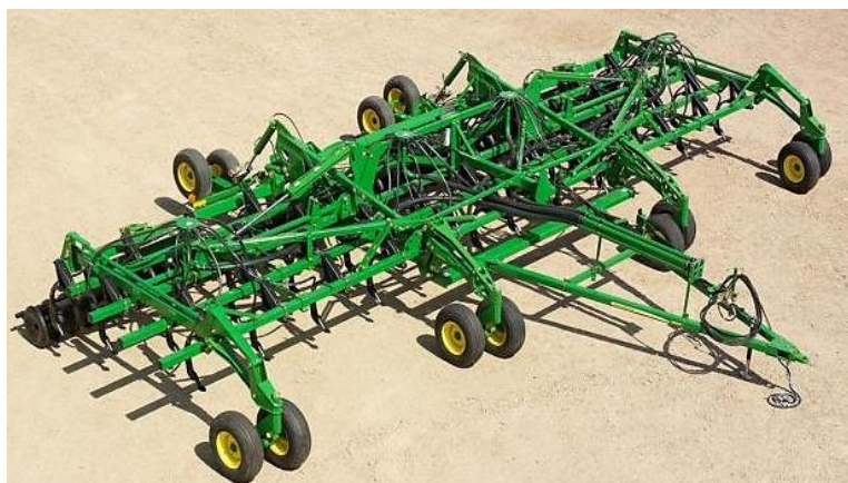
Рисунок 7. Широкозахватные сеялки культиваторного типа John Deere моделей 1830, 1835
