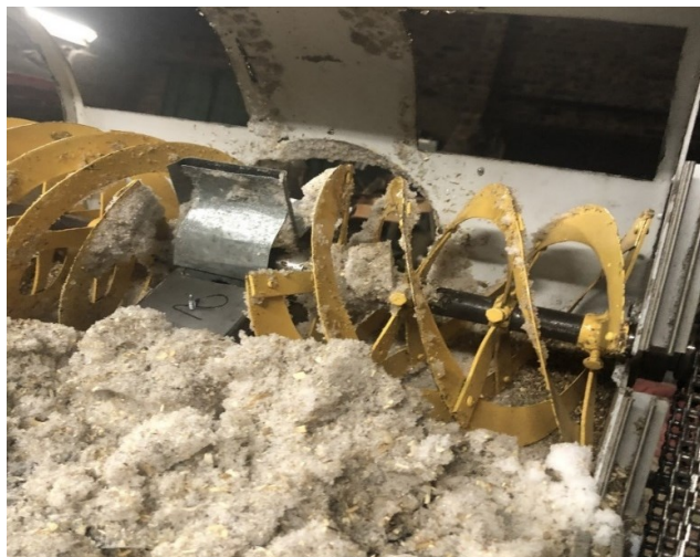
Рисунок 1. Винтовой питатель фрезерно-роторного снегоочистителя с лопастным интенсификатором
