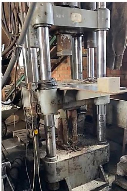
**Рисунок 1.** Пресс для изготовления брикетов-лизунцов
