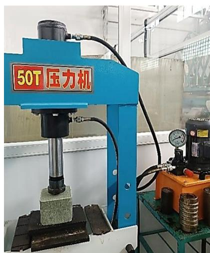
**Рисунок 2.** Гидравлический пресс для определения прочности брикетов-лизунцов
