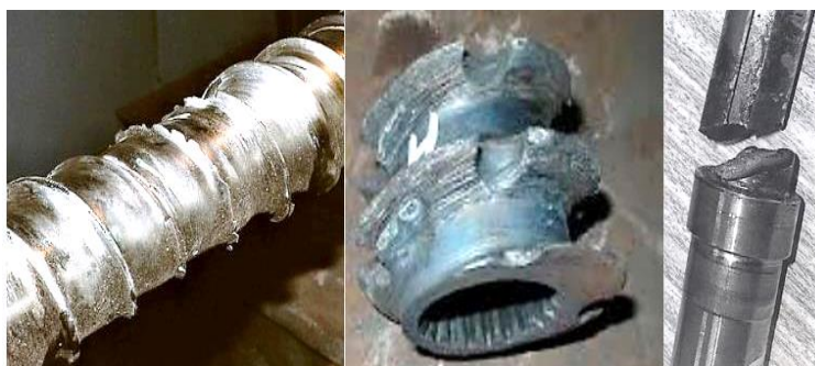
Рисунок 1. Образцы возможных поломок деталей экструдера
