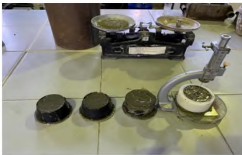
1-сурет. Вика құрылғысында модификацияланған қоспаның әртүрлі құрамдас бөліктерінің сынақ үлгілері
