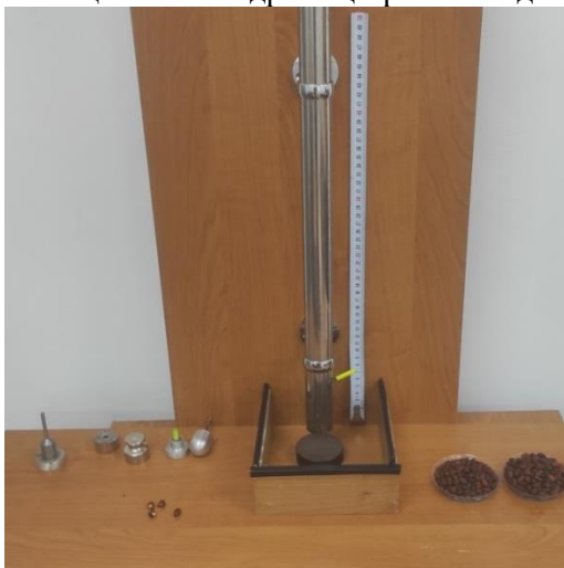
2-сурет. Соққы жүктемесін есептеуге арналған эксперименттік стенд Ескерту – автормен құрастырылған
