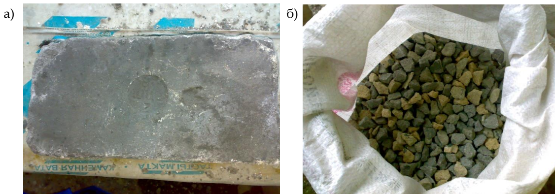
1-сурет. Вельц пешінің футеровкасының бұзылуы: а – ШКУ маркалы кірпіш б – 5–20 мм фракциялы ұсақталған ШКУ маркалы кірпіш
